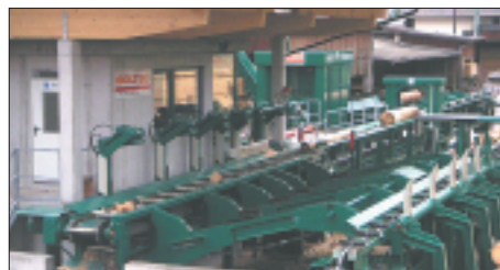
Kompletny zakład przerobu kłód. Wydajność do 20.000 metrów sześciennych rocznie przy pracy jednozmianowej.
