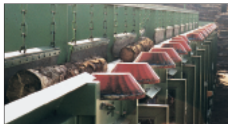
Sortowanie z wbudowanym wyrzutem dla kłód o małej średnicy
