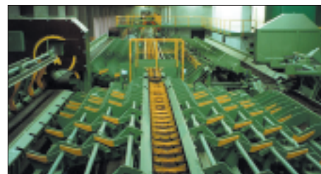
Przebieg podający i podwójna linia cięcia poprzecznego z systemem ustawiania wymiaru
