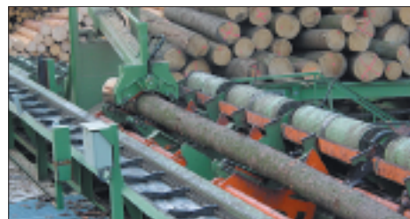
Podawanie kłód z wbudowanym reduktorem napływów korzeniowych
