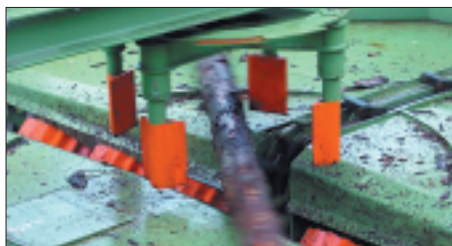
Urządzenia obracające w systemie podawania kłód z wbudowanymi rolkami przyspieszającymi
