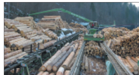
Linia sortowania wraz z systemem skanowania, opróżnianie boksów przy pomocy dźwigu manipulującego.
