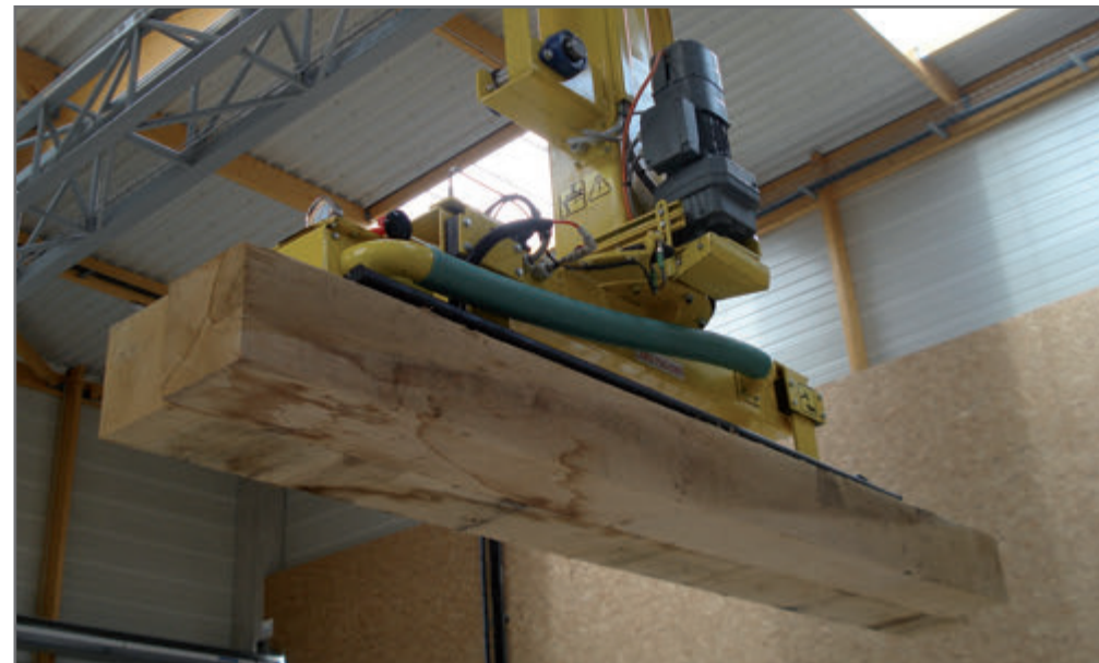
C : Obrót wyrobu w poziomie po jego uchwyceniu.
