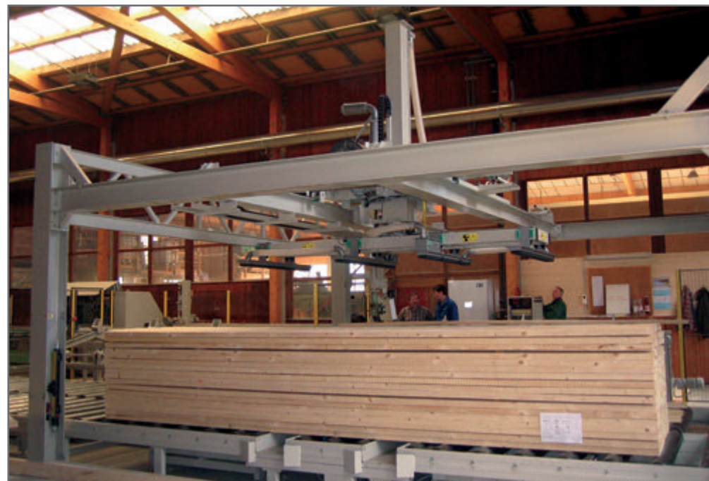
A : Szeroki rozstaw kolumn umożliwia podawanie szeroką stroną.
