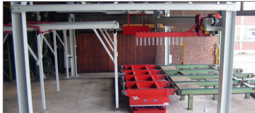
A : Podnoszony stół utrzymuje pakiet na ustalonej wysokości. Szczotka zgarnia przekładki.
