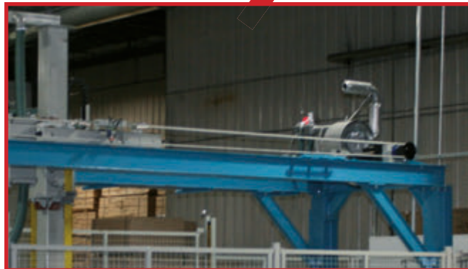
Wersja E : Pasek rozrządu z silnikiem zamocowanym na stałe na ramie.
