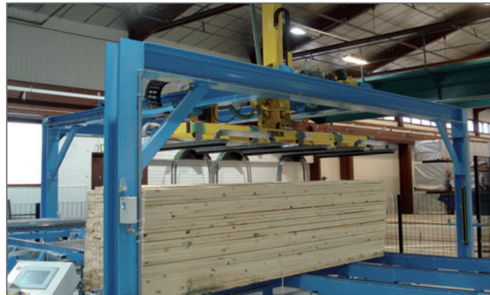
B : Dla podawania po długości wystarczy wąski rozstaw kolumn.
