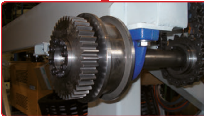
Wersja S : Zębatka na ramie i 2 mniejsze koła zębate napędzane przez silnik poruszający się na ramie maszyny.
