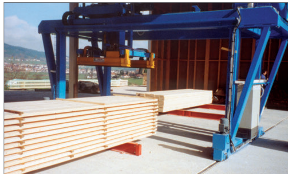
C : Mobilna jednostka chwytająca poruszająca się na ruchomej ramie umieszczonej na podłożu
