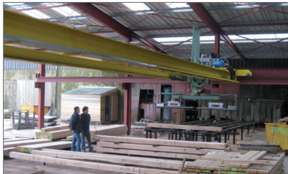
D : Mobilna jednostka chwytająca poruszająca się na ruchomej ramie zamocowanej na ścianie lub suficie.
