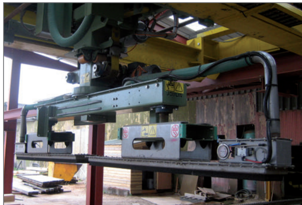
A : Przetawienie z chwytu pojedynczej części przez obrót o 90 ° umożliwia zabranie pełnej warstwy.
